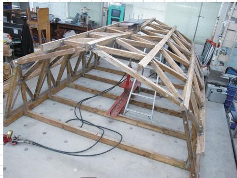
木質ヴォールト構造の破壊実験
