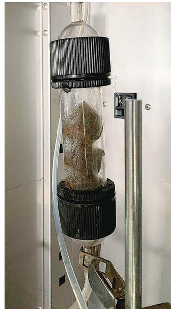
図1 環境中の微生物をバイオリアクターで培養している様子
