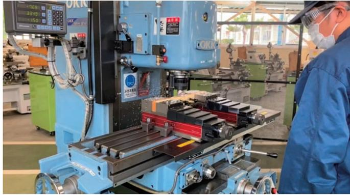
特に部品加工の際には、大きな機械で金属を削ったり、3Dプリンタで細かい形状の部品をつくったりと、活動の幅が広いです。写真は、フライス盤という機械を操作して材料を削っている様子です。
